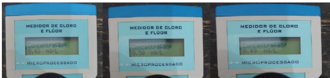
Foto 120 - Medição de cloro do P01
