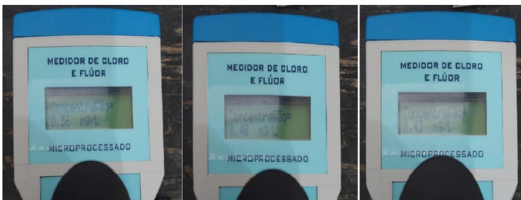
Foto 121 - Medição de cloro do P02
