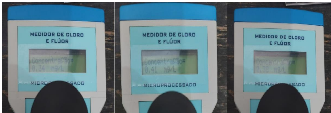
Foto 122 - Medição de cloro do P03
